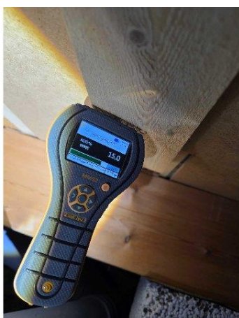
Bild 3: - Utvändigt, Grundmur/Hussockel, Krypgrund, se riskanalys Fuktmärken på trossbotten vänster om inspektionslucka. Markplats saknas ...
