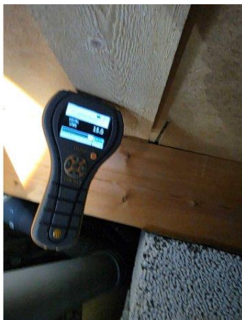
Bild 7: - Utvändigt, Grundmur/Hussockel, Krypgrund, se riskanalys Fuktmärken på trossbotten vänster om inspektionslucka. Markplats saknas ...
